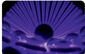
После насыщения поверхностного слоя азотом (**глубина слоя до 0,3 мм**) твердость изделия увеличивается **до 4-х раз**, при этом значительно повышается его износостойкость.
