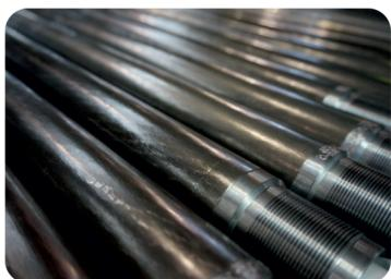
После ковки изделие не требует дополнительной механической обработки,
